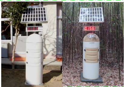
リアルタイム線量測定システム
