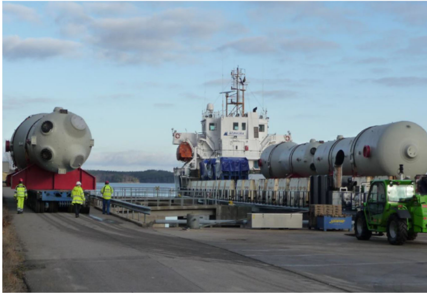
図 4.3 海上輸送された PWR 蒸気発生器の陸揚げ
