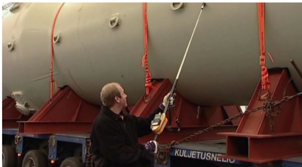
図 4.6 大型熱交換器の到着検査（線量率の測定）
