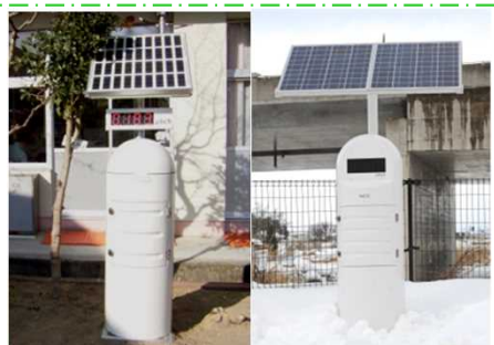
リアルタイム線量測定システム
