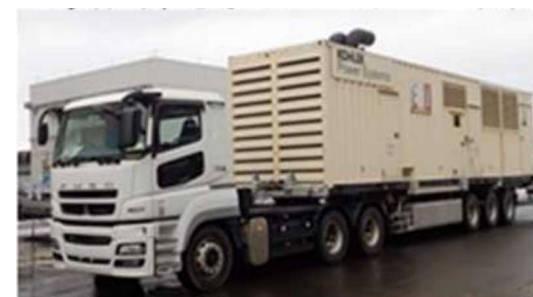
可搬型代替電源車
