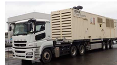
可搬型代替電源車
