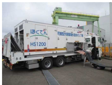
可搬型大容量海水 送水ポンプ車
