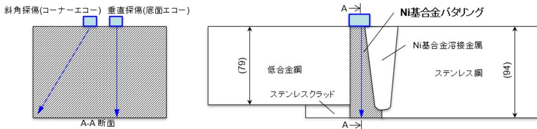
図 1 厚板継手溶接試験体
