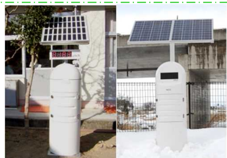
リアルタイム線量測定システム
