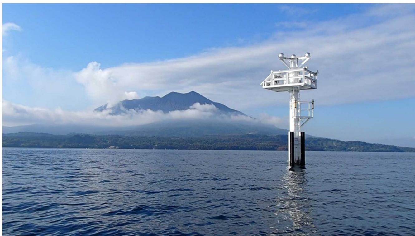
図5 海底地盤変動観測装置
