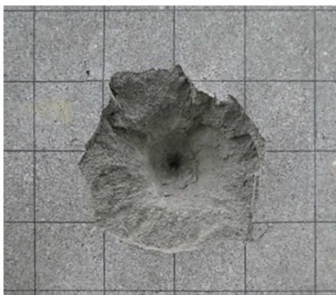
図4 半球型飛翔体貫入実験状況
