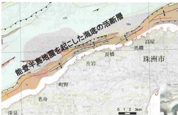
音波探査では、図中のように、断層は部分的に、かつ誤った位置にしか認定されていませんでした。しかし、変動地形学的手法では、能登半島地震を起こした活断層が、黄色線のように、すでに2012年に認定できていたのです。後藤秀昭(2012) 広島大学文学研究科論文集、72
