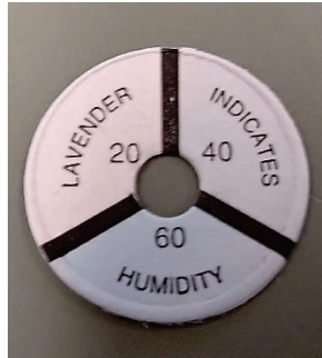
写真 2.1.4-1 検出器内の湿度確認用インジケーター（指示値が 40%の場合）
