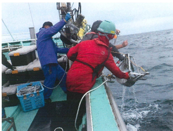
写真 3 海底土の採取状況 (採泥器の引き上げ)
