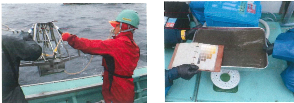
図 2-5 海底土試料の採泥状況
