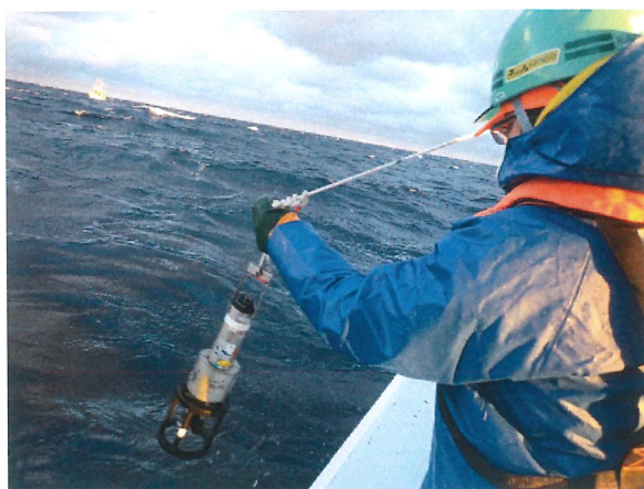
写真 8 CTD による測定 (水深、塩分濃度の測定)
