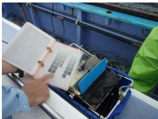
⑥表層海底土の採取状況（泥色目視確認）
