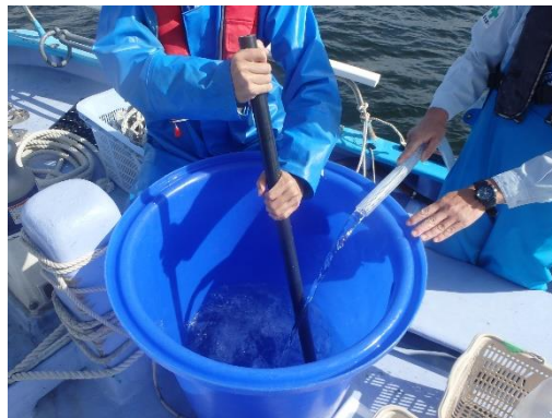
③水中ポンプを用いた海水試料採取作業
