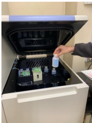
⑤トリチウムを定量するため、液体シンチレー ションカウンタに測定用試料を投入する様子
