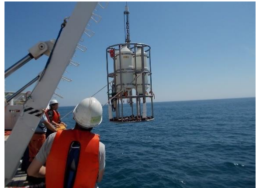
②大型バンドーン採水器の投入
