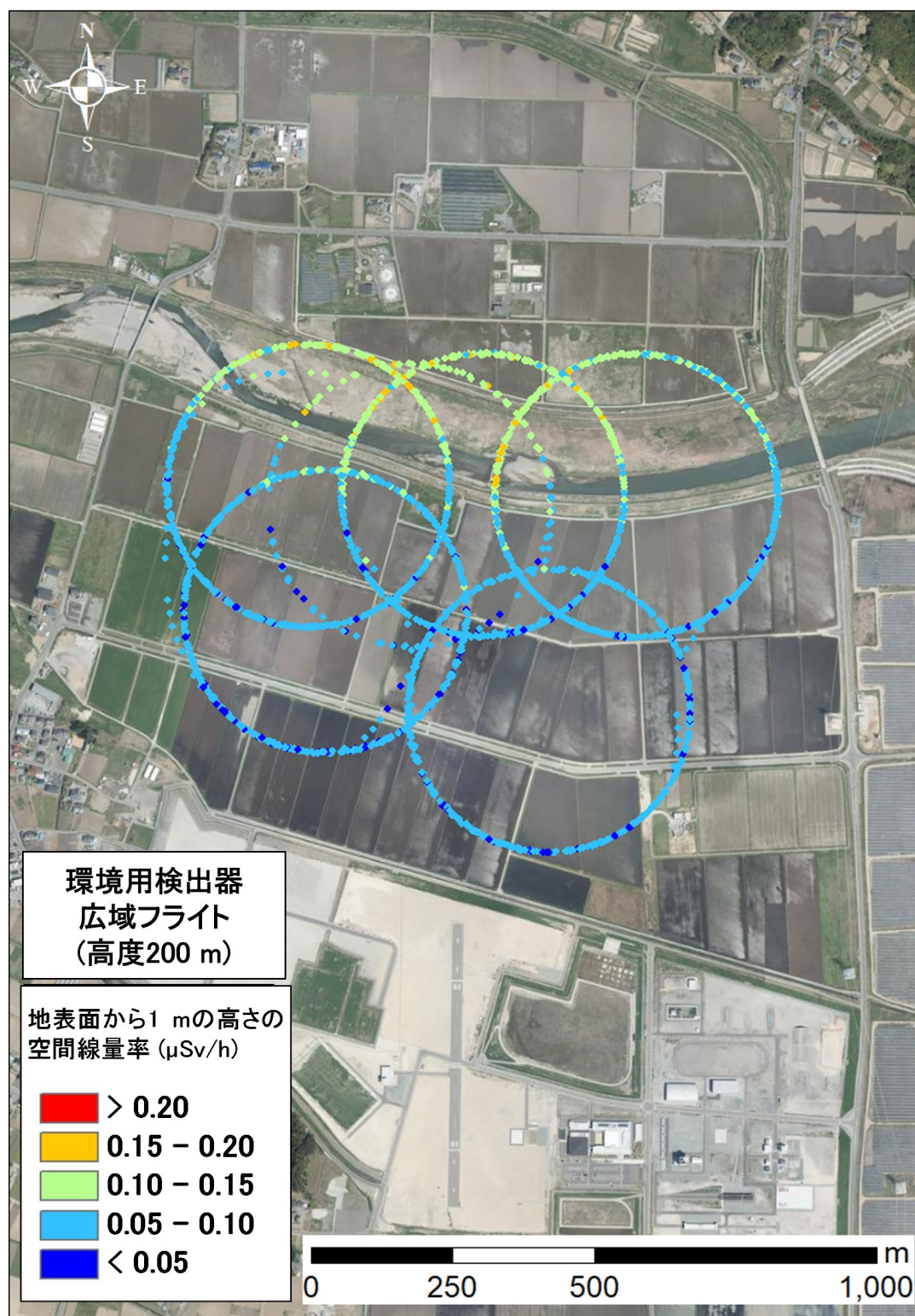
Fig. 9-33 無人航空機測定による空間線量率マッピング結果 (2024 年 12 月 2 日測定) (背景地図は、地理院地図 Vector 78) に Penguin C のフライト軌跡及び地表面から 1 m の高さ の空間線量率を追記して掲載)
