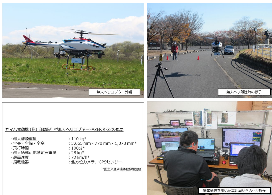
Fig. 3-6 無人ヘリモニタリングシステムを搭載した FAZER R G2
