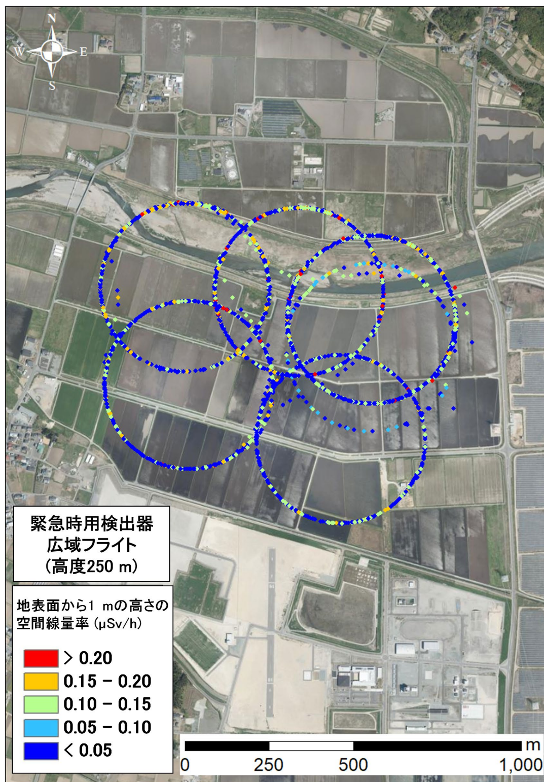
Fig. 9-31 無人航空機測定による空間線量率マッピング結果 (2024年7月12日測定) (背景地図は、地理院地図 Vector 78) に Penguin C のフライト軌跡及び地表面から1 mの高さの空間線量率を追記して掲載)
