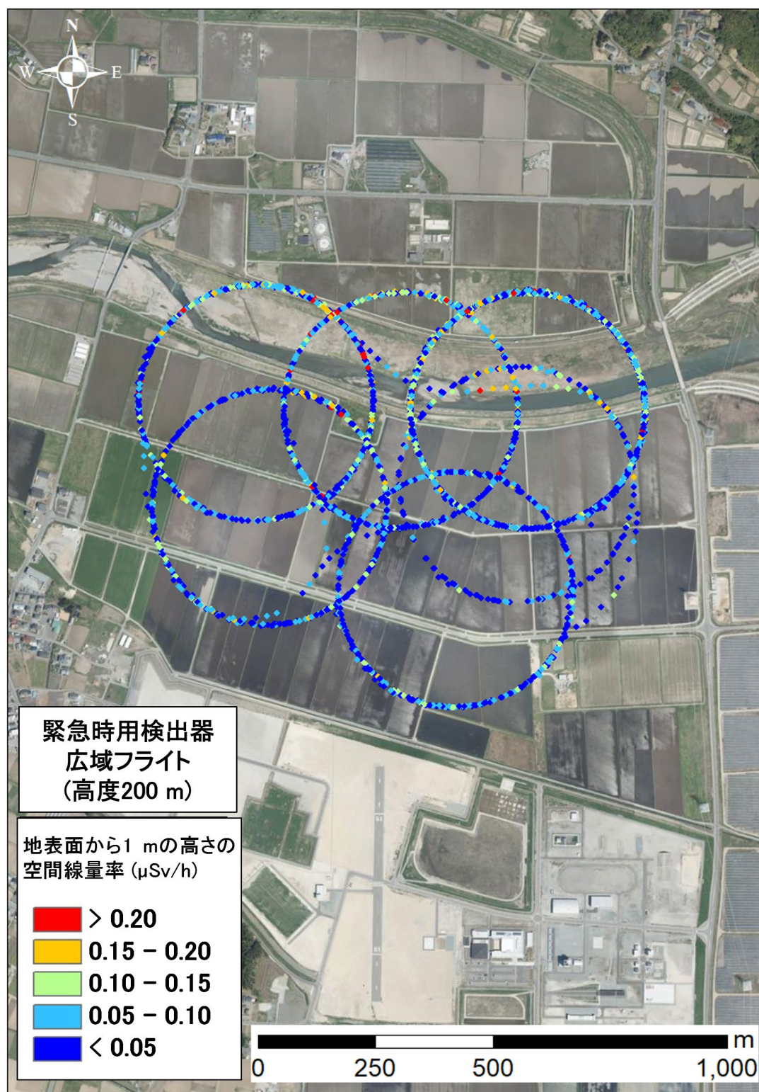
Fig. 9-30 無人航空機測定による空間線量率マッピング結果 (2024年7月11日測定) (背景地図は、地理院地図 Vector 78) に Penguin C のフライト軌跡及び地表面から1 mの高さの空間線量率を追記して掲載)
