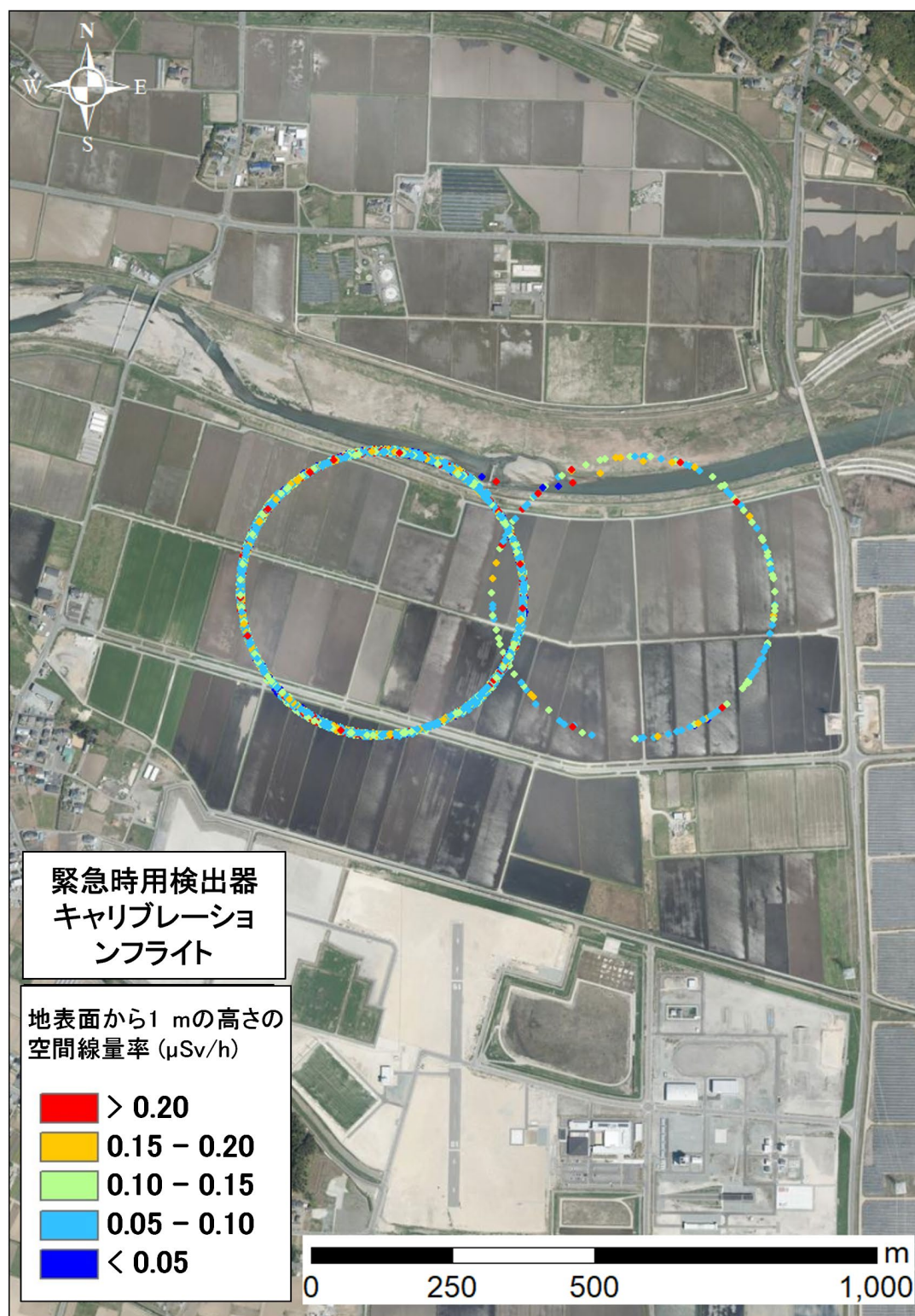
Fig. 9-32 無人航空機測定による空間線量率マッピング結果 (2024年9月11日測定) (背景地図は、地理院地図 Vector 78) に Penguin C のフライト軌跡及び地表面から1 mの高さの空間線量率を追記して掲載)
