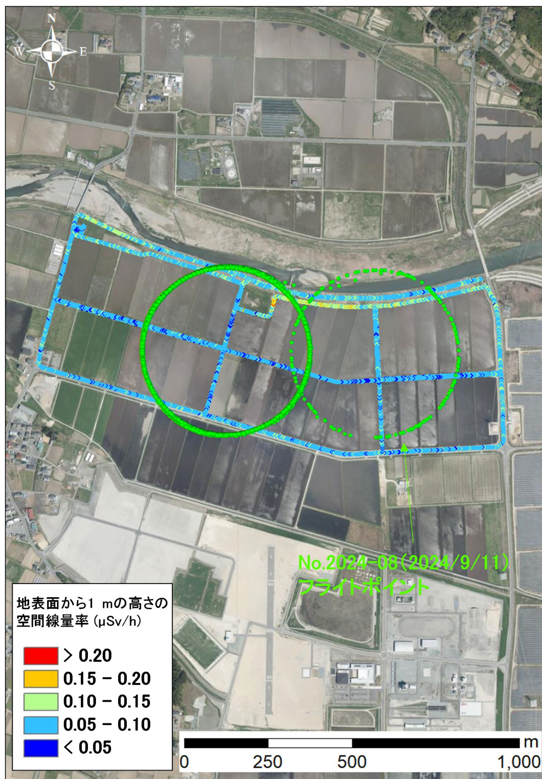
Fig. 9-24 歩行サーベイによる地上 1 m 空間線量率測定結果 (2024 年 9 月 11 日実施) (背景地図は、地理院地図 Vector 78) に Penguin C のフライト軌跡及び歩行式サーベイメータ で得られた地表面から 1 m の高さの空間線量率を追記して掲載)
