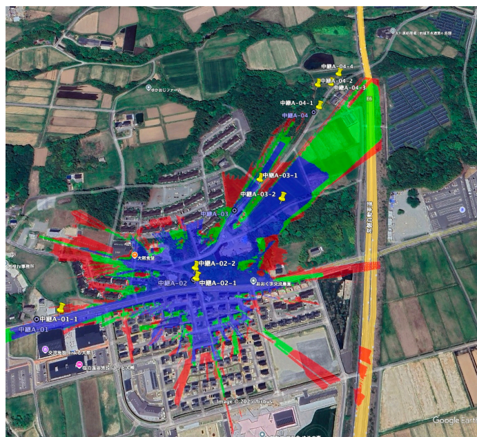
図 37 中継 A-02～A-03 の位置関係と A-02 に送信機を設置した際のヒートマップ。
