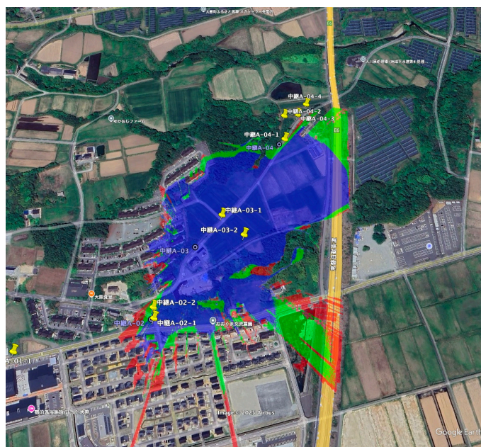
図 38 中継 A-03～A-04 の位置関係と A-03 に送信機を設置した際のヒートマップ。
