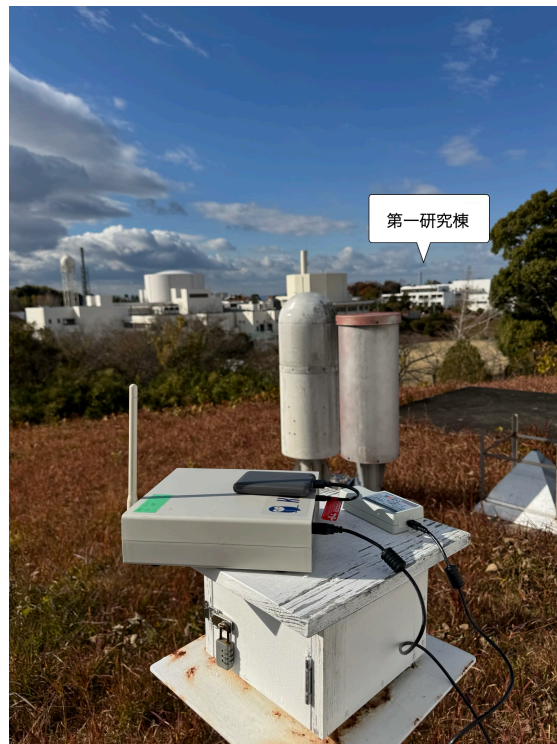
図 19 気象観測塔の直下にあるモニタリングポスト付近に設置した超小型 KURAMA-II。第一研究棟屋上が目視できる位置である。
