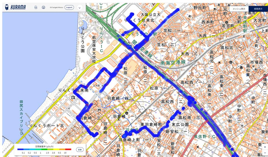
図 4 りんくうタウン付近における内蔵 GNSS による自動車走行中の測位結果。測定点の赤は同時に調整中だった検出器とのデータ転送同期が外れた場合の空データを意味しており、異常な線量率が観測されたわけではない。
