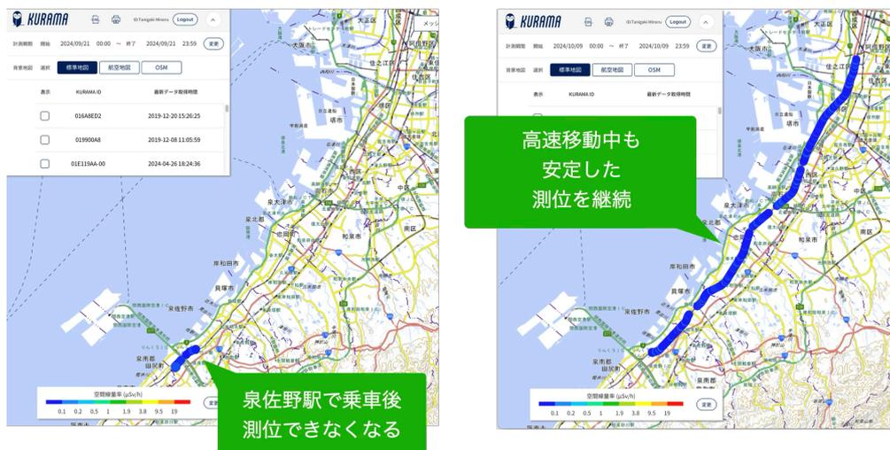
図 7 南海電鉄の特急ラピートに搭載し、泉佐野駅～天下茶屋駅間で測定した際の内蔵 GNSS（左）と GNSS add-on（右）の比較。内蔵 GNSS の場合は測位が可能になるまでに時間がかかることから、ラピートに乗車する泉佐野駅よりも前で動作を開始させたが、ラピートに乗車して設置した後は終点まで測位ができないままであった。一方 GNSS add-on の場合は概ね全区間にわたって測位ができています。一部データがない区間は LTE-M 規格のハンドオーバー時の遅延に伴うものである。
