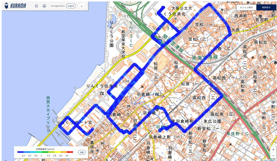
図5 りんくうタウン付近における GNSS add-on による自動車走行中の測位結果。Sony から公開されている測位品質の向上例のように、内蔵 GNSS に比べ大幅な改善が見られることがわかる。
