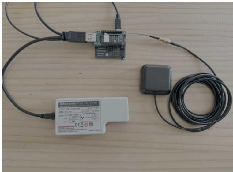
図 3 今回試作した GNSS add-on 搭載超小型 KURAMA-II。昨年度の事業で製作したものと共通である LTE 拡張ボード、Spresense 本体、USB Host add-on がスタックされた本体部分に、さらに今年度追加となった GNSS add-on 基板がスタックされている。
