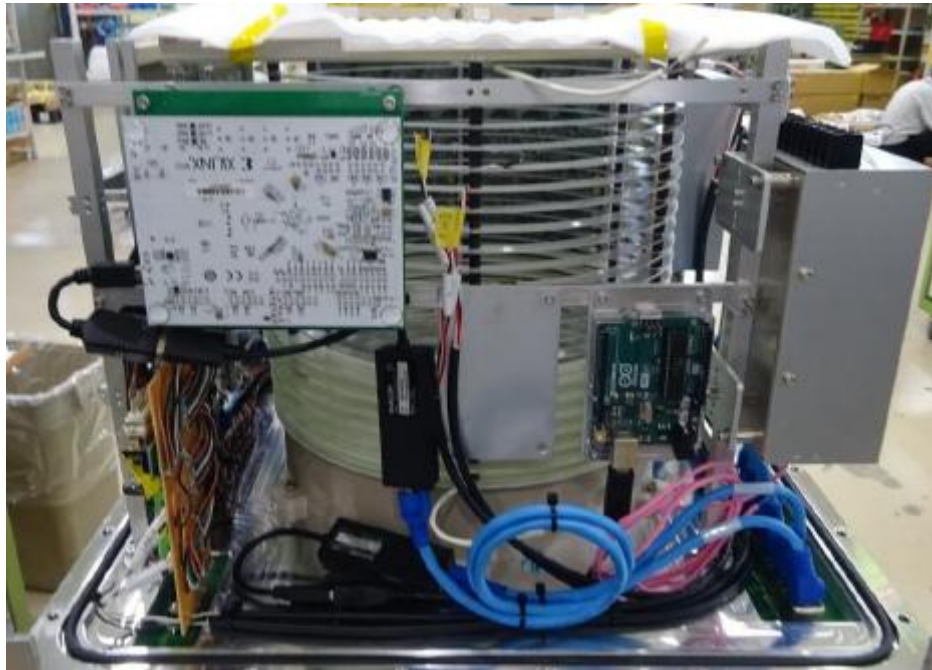
図 A-24 ドリフトケージの取付
