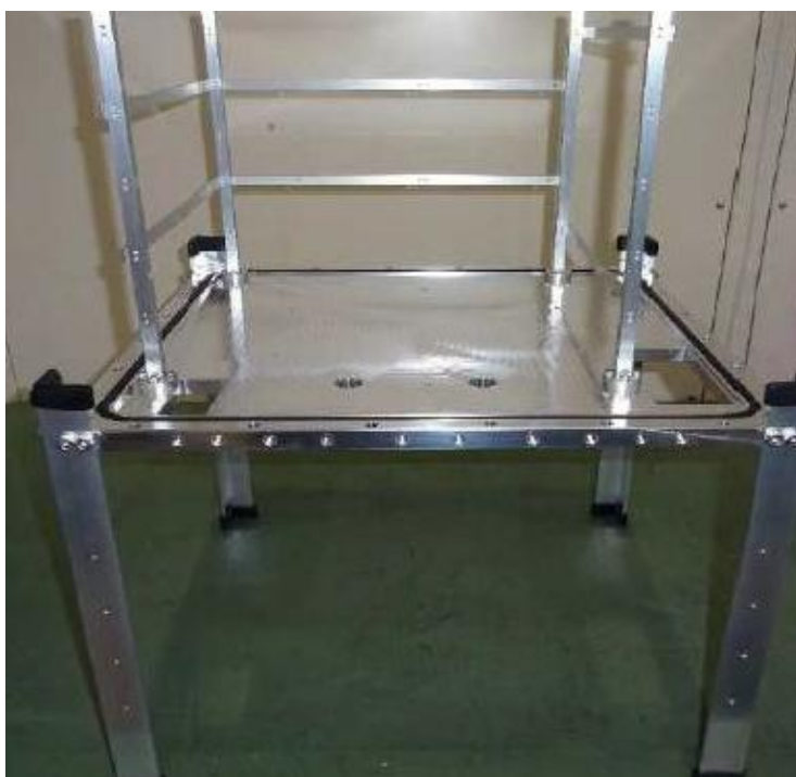
図 A-5 底板へ支柱を取付
