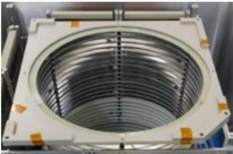
図 2-10 GEM の取付枠 (ドリフトケージ上に設置)
