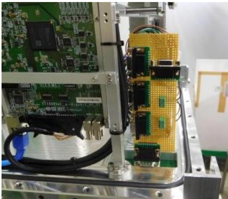
図 A-16 電源分配基板の取付
