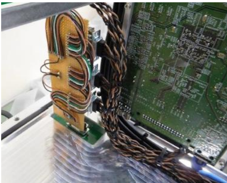
図 A-17 電源分配基板側のハーネス接続
