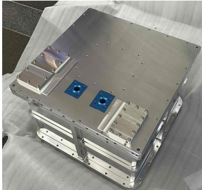
図 2-5 改造 TPC 容器の底面(ガス配管接続口、基盤導入機構を設置)
