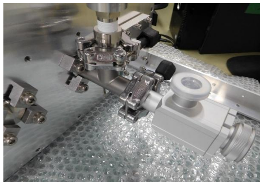
図 2-27 真空試験のための装置取付(容器底面)
