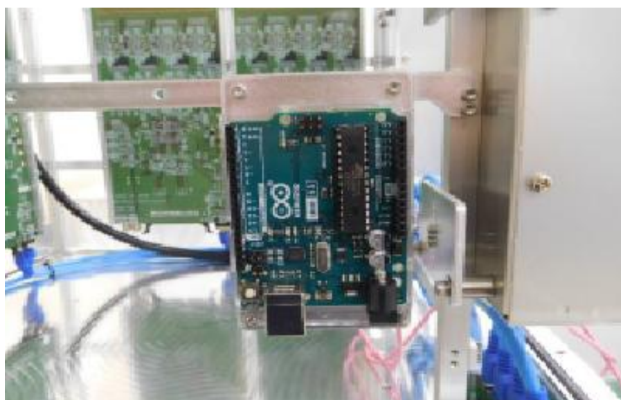
図 A-12 アルディーノ(HV 制御用マイクロ PC)の取付
