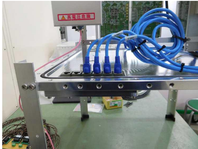
図 2-15 信号中継基板からイーサネット基盤への接続
