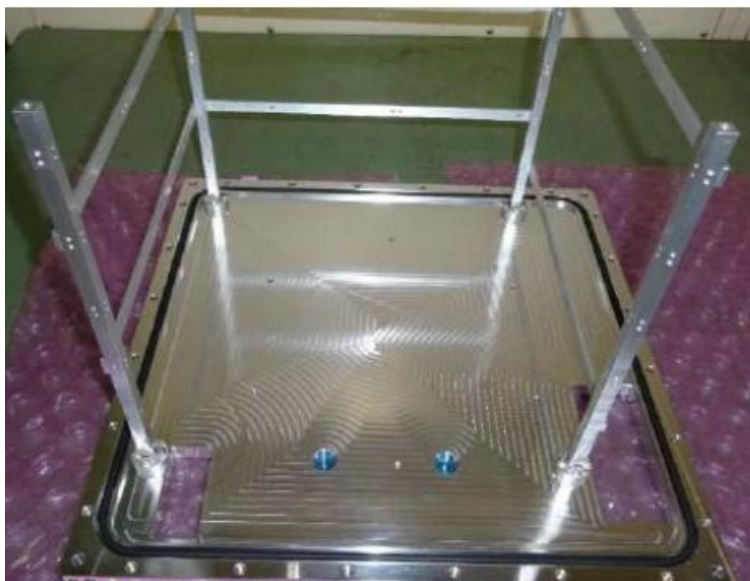
図 A-4 底板と大 L 字治具（脚部）の取付
