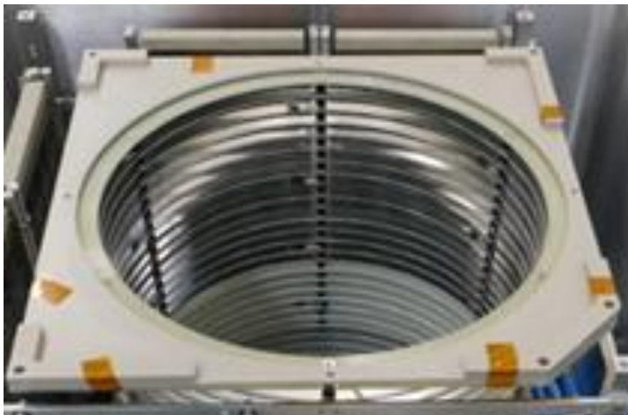
図 A-25 GEM 枠の取付 (ドリフトケージ上部)
