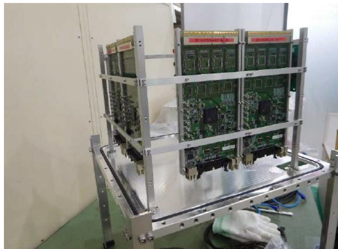
図 2-14 信号中継基板の取付
