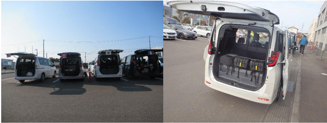
Fig. 8-12 車両を用いた走行サーベイに用いた放射線検出器の搭載状況
