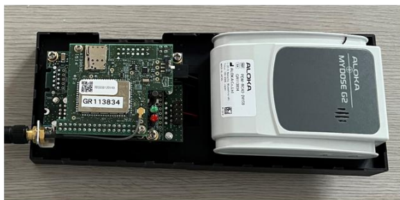
Fig. 6-12 マルチコプター搭載用放射線検出器情報及び外観
