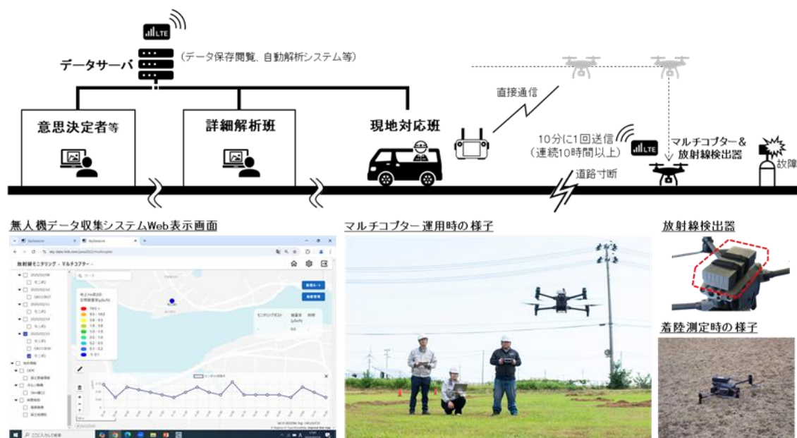
Fig. 6-10 マルチコプターを用いた空間線量率測定システムの概要
