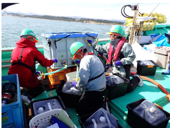
写真 9 海水の採取状況 (20 L 容器への分取)
