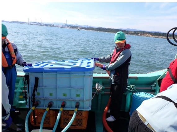
写真 7 海水の採取状況 (ポンプによる採水)
