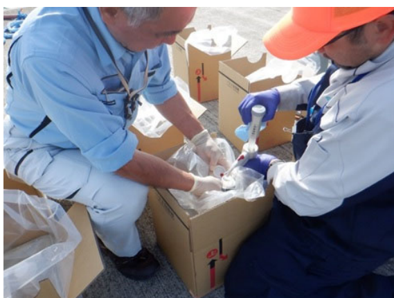
写真 15 採取した海水に酸を添加
