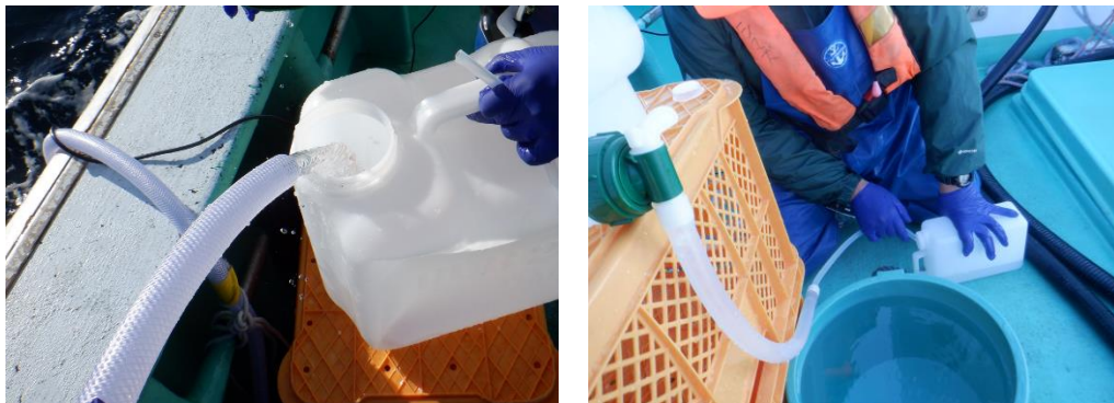
図 2-2 海水試料の採水状況
