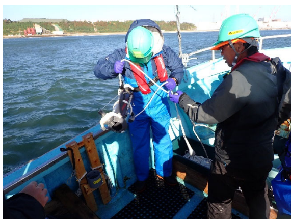
写真 11 海水の採取状況 (ニシン採水器による ^3\text{H} 分析用海水の採取)
