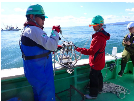
写真 3 海底土の採取状況 (採泥器を下す)
