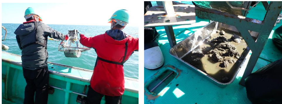
図 2－5 海底土試料の採泥状況
