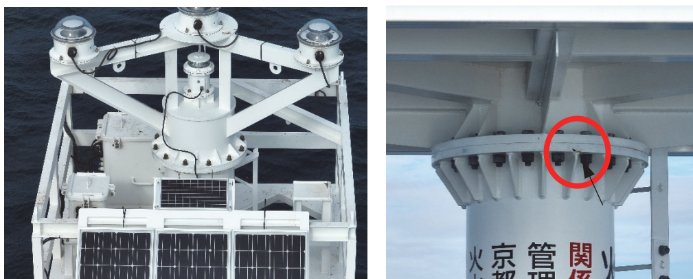
図 2-1-13. 空中ドローンによって撮影された海底地盤変動観測装置の状況
