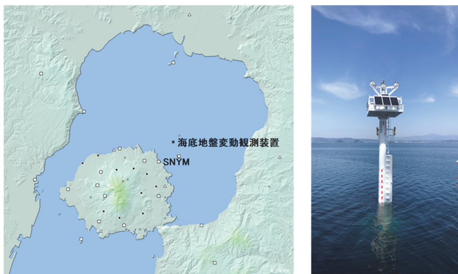
図 2-1-2. 海底地盤変動観測装置の設置位置（左図）と海上部の外観（右図）
