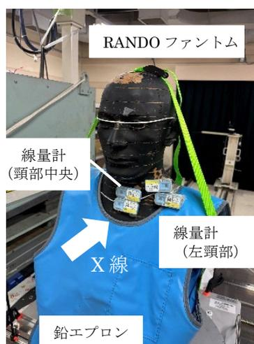
図 J 4-77 ファントム照射試験の様子
