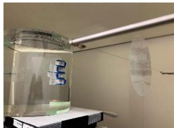
図 4.4.1.3-6 線量計 E2 の照射試験時の配置。照射角度 0 度の場合を示す。いずれの入射角度の場合も 4 個同時に照射した。
