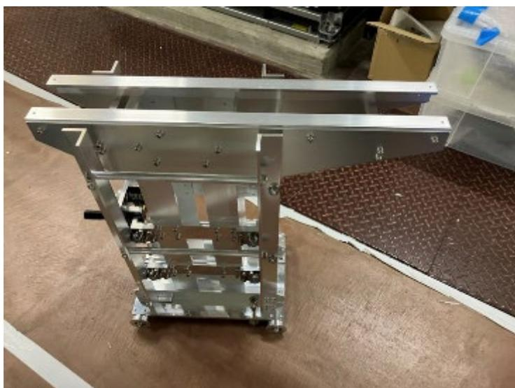
図 4.2.2-1 熱中性子校正用台車
