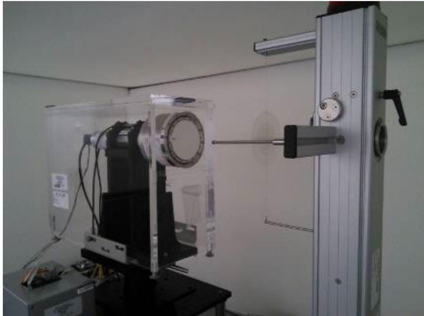
図 2.3-5  $\beta$ 線照射装置と外挿電離箱
