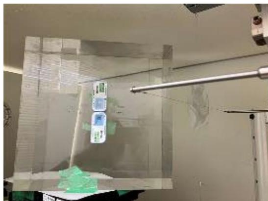
図 4.4.1.3-2 線量計 B1 の照射試験時の配置。照射角度 45 度の場合を示す。2 個同時に照射した。15 度、30 度、60 度、75 度においても 2 個同時に照射した。
