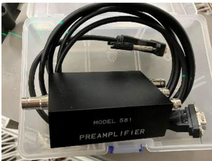
図 4.2.2-2 低雑音電荷有感型前置増幅器
