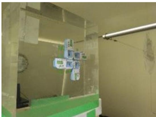
図 4.4.1.3-1 線量計 B1 の照射試験時の配置。照射角度 0 度の場合を示す。4 個同時に照射した。
