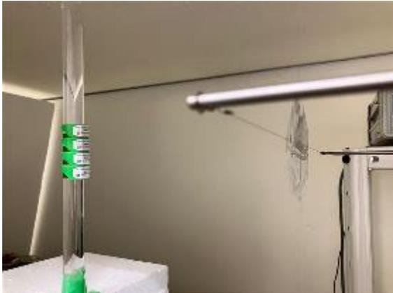
図 4.4.1.3-7 線量計 R3 の照射試験時の配置。照射角度 0 度の場合を示す。いずれの入射角度の場合も 4 個同時に照射した。
