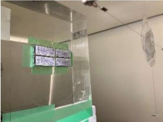
図 4.4.1.3-3 線量計 B2 の照射試験時の配置。照射角度 0 度の場合を示す。4 個同時に照射した。
