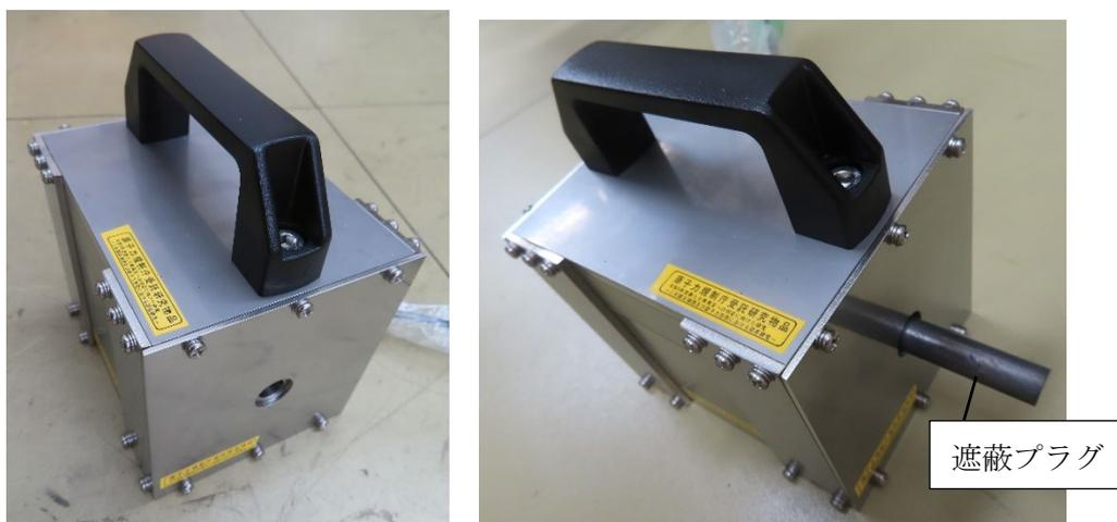
図 J 4-67 コリメータの組立て構造図（上）及び外観（下）
