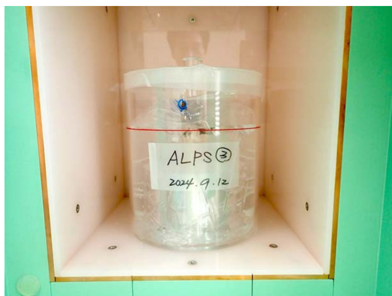
図 4.2.3-2 \gamma 線分析用試料（特注マリネリ容器に ALPS 処理水試料 2 L を入れたもの）
