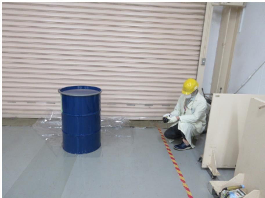
(b) 輸送容器の線量率測定作業(輸送容器表面から1m位置)
