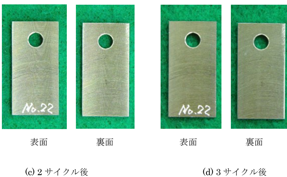
図 3.3.2(2)-1 (10/12) 試験前後の試験片外観 (TP No. 22 : SP 施工なし、酸化皮膜なし)
