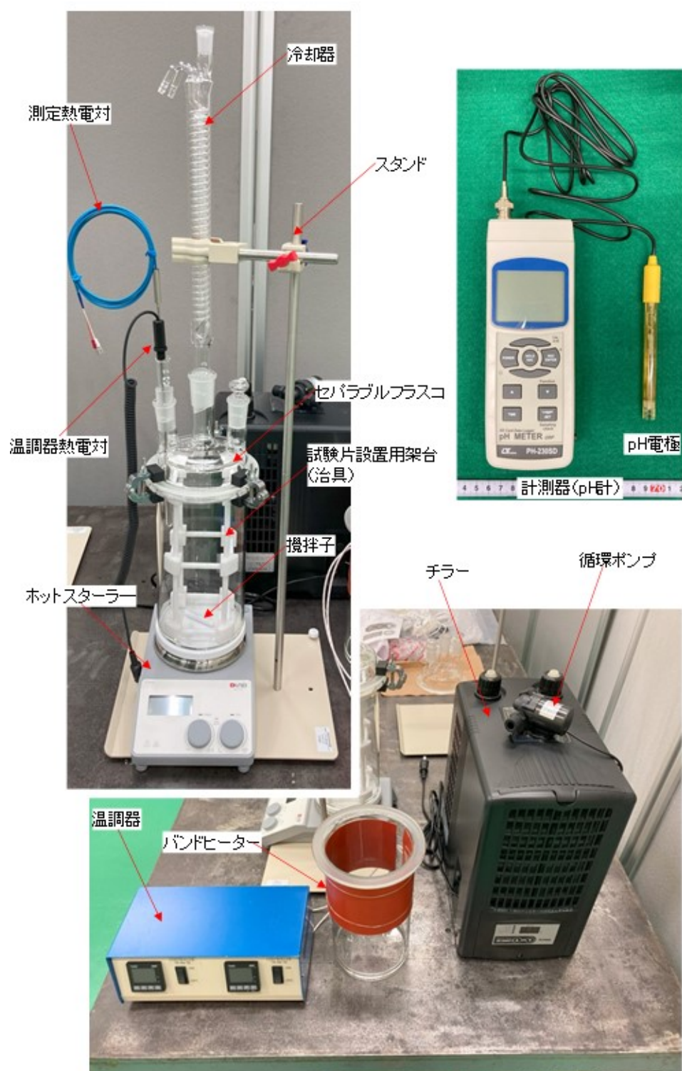
図 3.3.2(1)-7 除染試験装置外観
