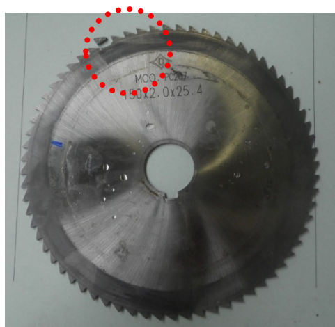
図 3. 2. 1. 1-9 刃の欠けが発生した円盤ソーと欠けた刃の切断対象板への詰まり (赤色破線部)
