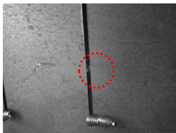
図 3. 2. 1. 1-9 刃の欠けが発生した円盤ソーと欠けた刃の切断対象板への詰まり (赤色破線部)
