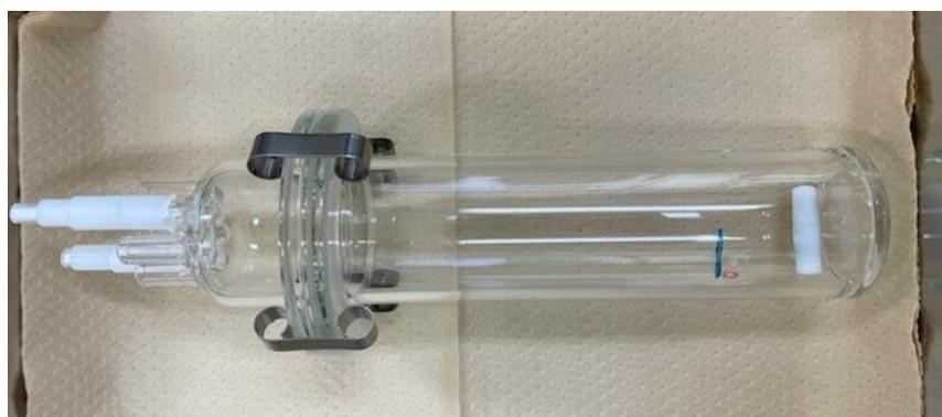
図 2.15 使用した加熱容器（セパブルフラスコ）の外観
