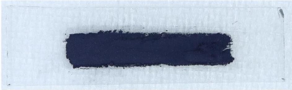
図 3.150 RuO<sub>2</sub> 塗布ガラス検体の外観
