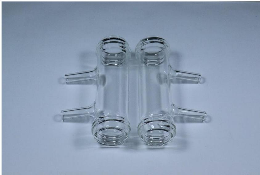
図 3.30 試験終了後の反応容器の外観 (Glass-Air-25)
