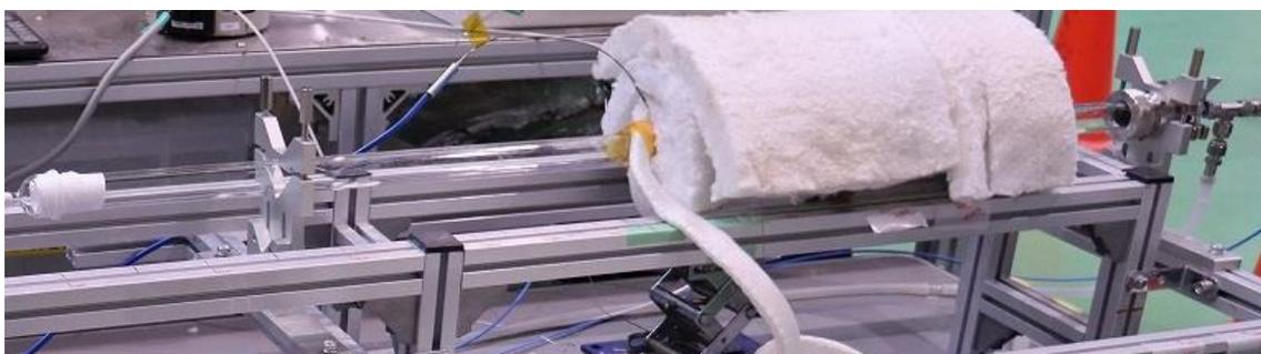
図 5.2 Cs 化合物等移行挙動試験装置の写真
