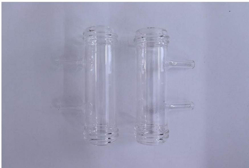
図 3.32 試験終了後の反応容器の外観 (Glass-NO<sub>x</sub>-130)
