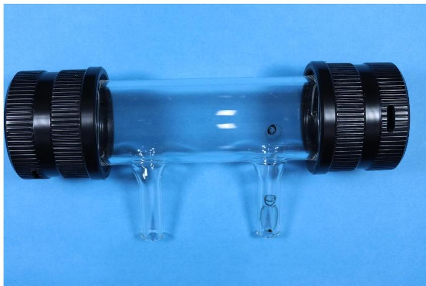
図 3.31 試験終了後の反応容器の外観 (Glass-HNO<sub>3</sub>-130)
