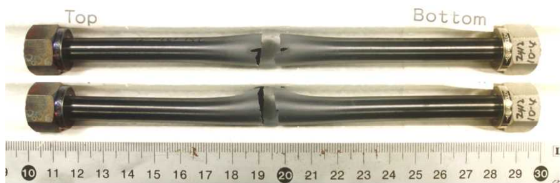
図 4.2.3-6 繰り返し荷重負荷四点曲げ試験後の試料外観一例
