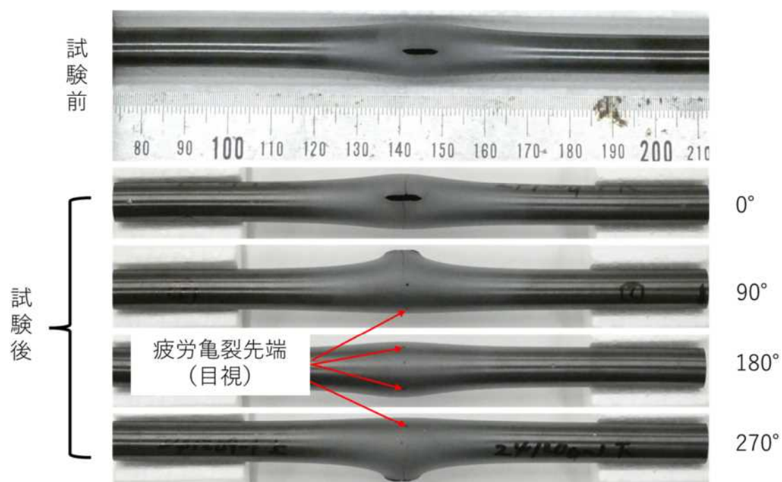
図 4.2.3-11 四点曲げ疲労試験前後試料①の疲労亀裂の様子
