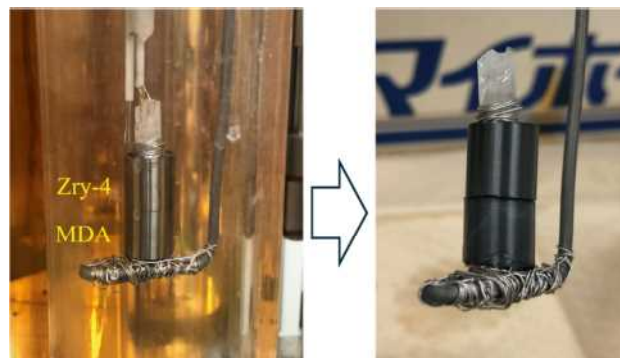
図 4. 1. 2-3 酸化前及び酸化試験後の試料の写真 (各酸化試験では、Zry-4 は上部に、MDA は下部に配置)
