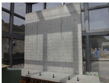
a) 中型平板試験体実験前外観 及び裏面剥離状況（衝突速度 80.7m/s）
