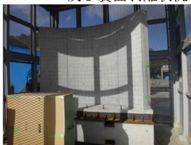
b) 中型アーチ試験体実験前外観 及び裏面剥離状況（衝突速度 81.6m/s）
