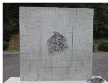
a) 中型平板試験体実験前外観 及び裏面剥離状況（衝突速度 80.7m/s）
