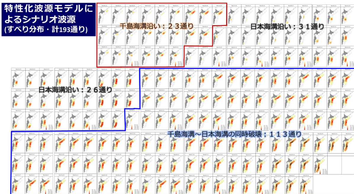
図 2.2.2 日本海溝から千島海溝のプレート間地震を対象として得られた特性化波源断層に基づくシナリオ波源のすべり分布
