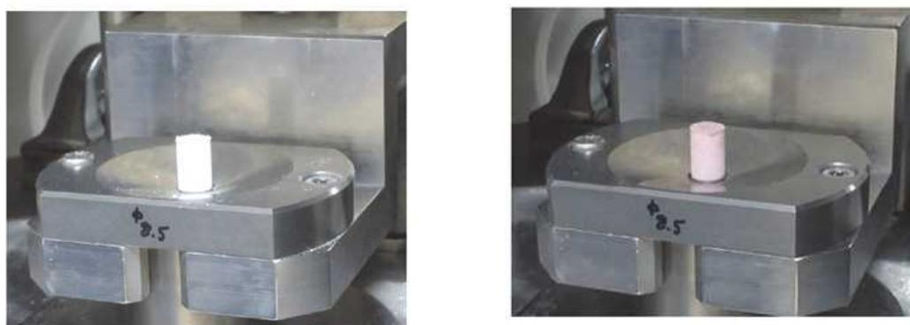
酸化アルミニウム ( $\text{Al}_2\text{O}_3$ ) ペレット      酸化ジルコニウム ( $\text{ZrO}_2$ ) ペレット
