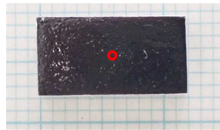
(a) S1Y-1 (クラッド直下、 9.3 \times 10^{18} \text{ n/cm}^2 )
