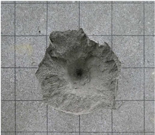
図4 半球型飛翔体貫入実験状況 （来待石、衝突速度 160m/s） (9)
