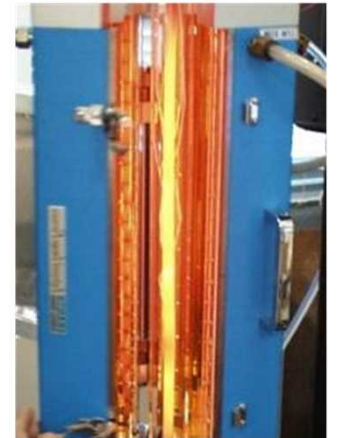
配管の破断などにより 冷却水が失われる事故を 模擬した燃料棒高温試験の様子
