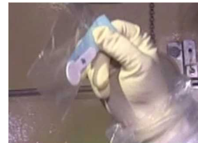
原子炉建屋壁面をふき取ったろ紙
