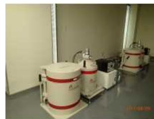
ゲルマニウム半導体検出器 (放射能核種分析用器材)
