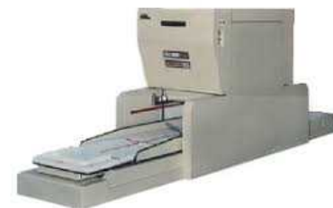
線量評価関連資器材（ホールボディカウンタ）設備整備
