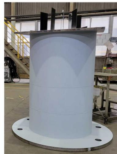
縮尺試験体の鋼構造部
