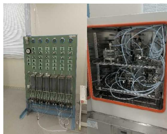
図6 ベントナイト系人工バリアの変質試験に用いる透水試験装置
