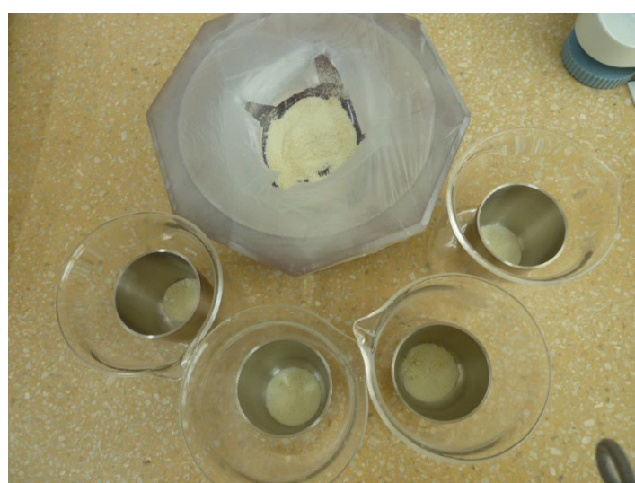
図 7.2-5 粉碎したペレット試料及び融剤分取後の状態
