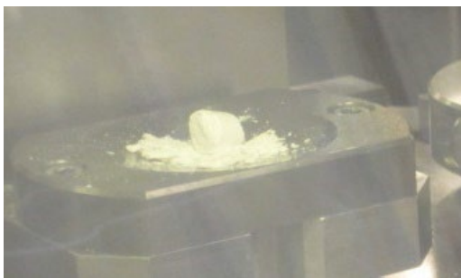
成型不可 (粒径 254\mu\text{m} 、15 MPa)
