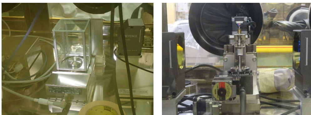
図 7.2-2 重量測定及び体積測定
