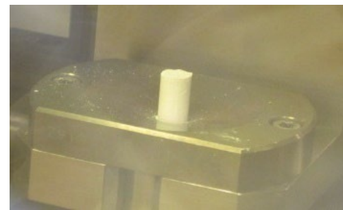
キャッピング (粒径 1\mu\text{m} 、15 MPa)
