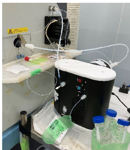
図 9-1-2 QST 所有の脱溶媒装置 (APEX)
