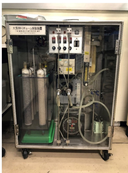
図 2-3-11 大気中トリチウム採取装置と概略図
