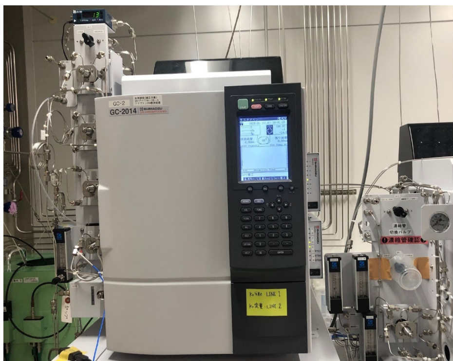
図 3-8-7 ガスクロマトグラフ 2 (分離・精製及び精密分析用)
