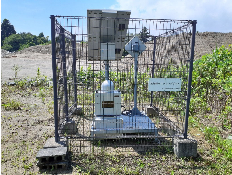
図 2-10-15(1) 更新前の可搬型モニタリングポスト (養護老人ホーム「東風荘」(富岡町) : 2023 年 8 月 16 日撮影)
