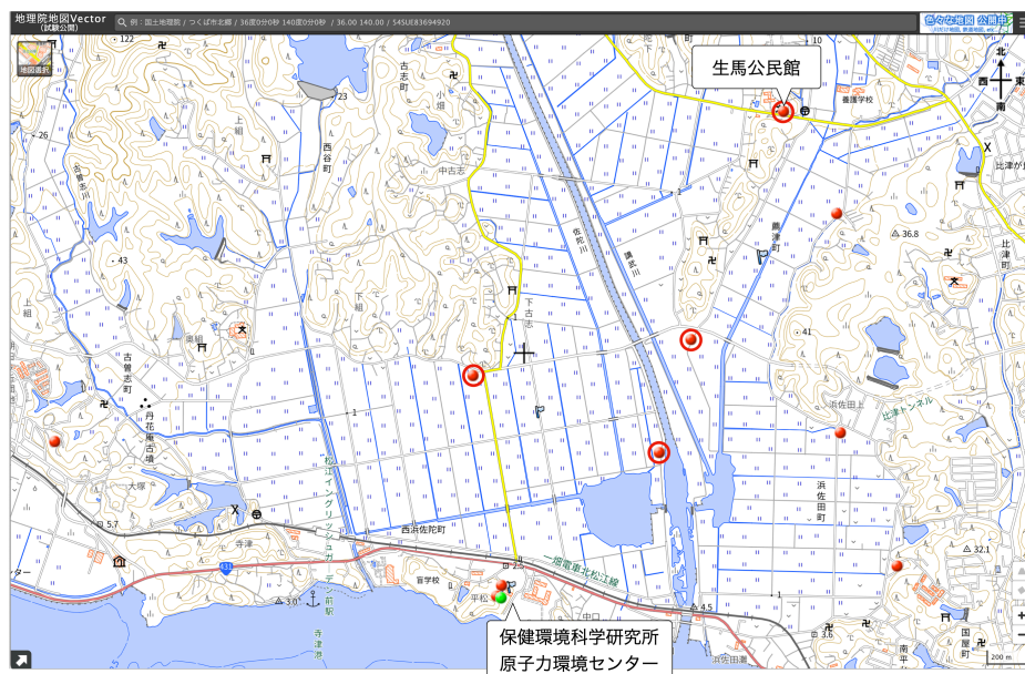
図 11 試験において Wi-SUN FAN 機器が設置された地点。緑丸が拠点となる原子力環境センター、旗印が中継局（Wi-SUN FAN 機能のみ）、赤丸が Wi-SUN FAN 対応 KURAMA-II の設置箇所。赤の二重丸の各地点は実際に KURAMA-II からのデータがサーバのマップ上に表示された地点。
