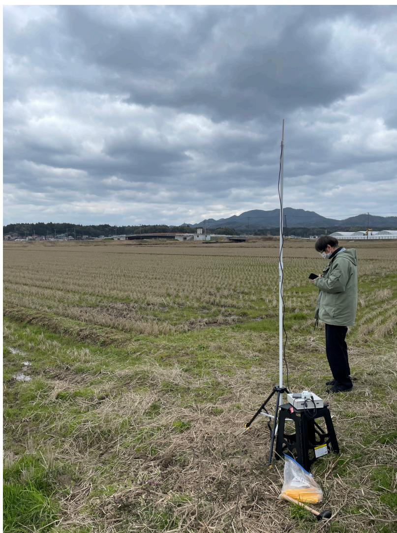
図9 試験中に設置された Wi-SUN FAN 対応 Spresense ベース超小型 KURAMA-II。本体は高さ 40 cm 程度の台の上に置き、5000 mAh のモバイルバッテリーで稼働させた。アンテナについては、この画像のように 1/2\lambda の垂直アンテナを 2 m 程度の高さまで上げている場合と、本体に 1/2\lambda の垂直アンテナを直結して地上高 0.5 m 程度で設置している場合がある。
