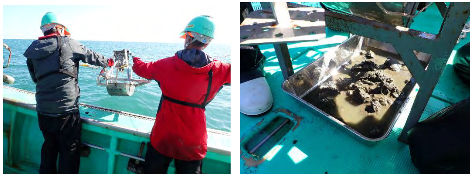
図 2-5 海底土試料の採泥状況
