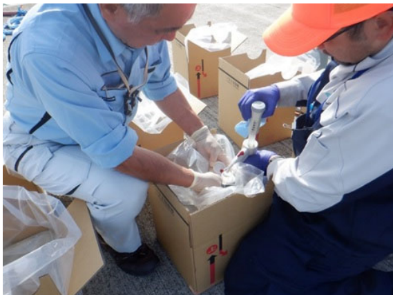
写真 15 採取した海水に酸を添加
