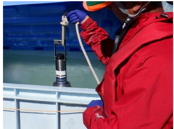
写真8 海水の採取状況 (塩分の測定)
