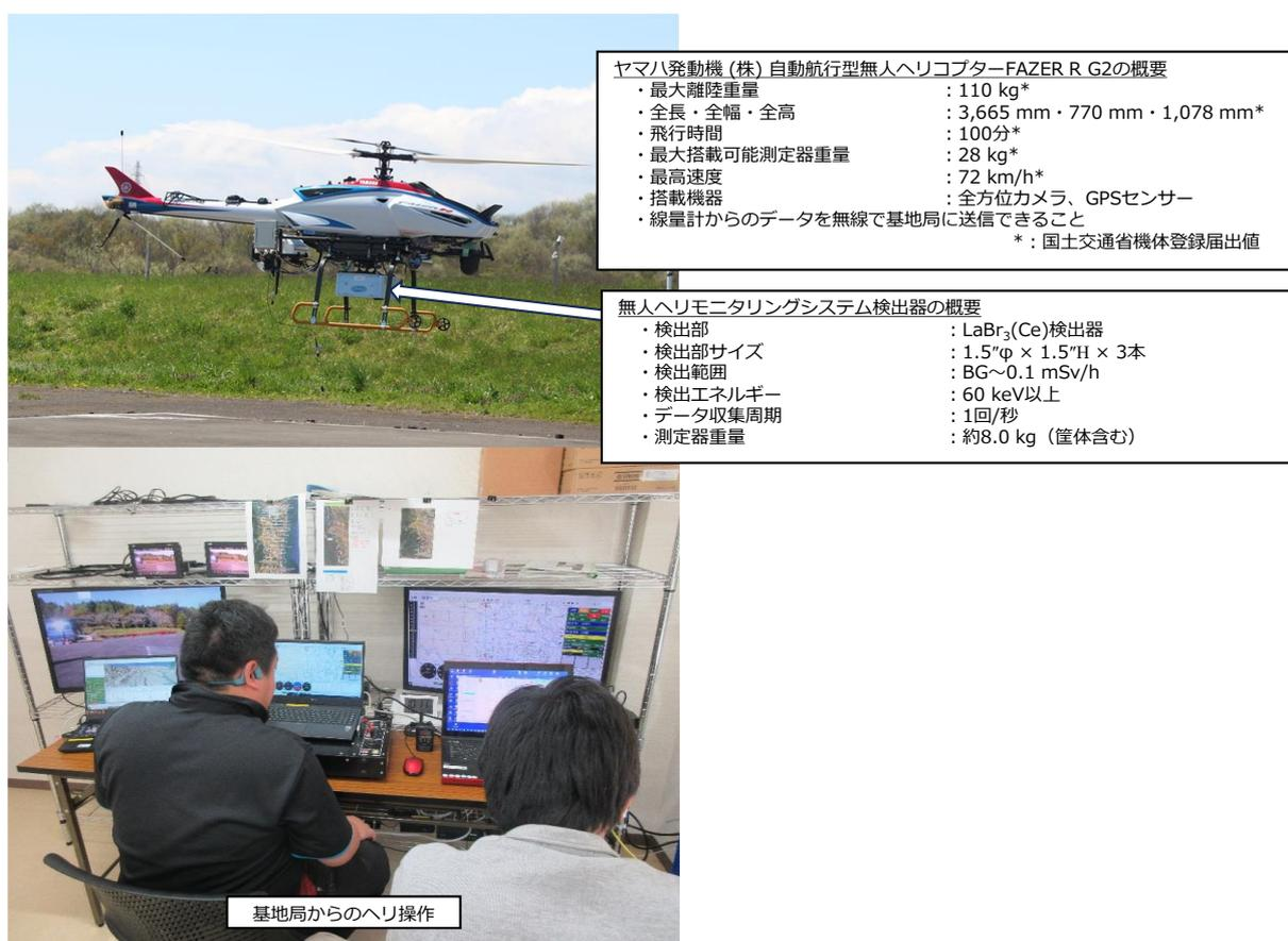
Fig. 3-6 無人ヘリモニタリングシステムを搭載した FAZER R G2
