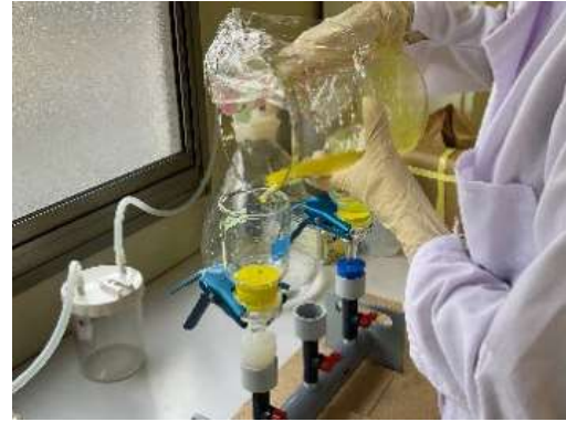
②放射性セシウム分析の際のリンモリブデン 酸アンモニウム（黄色粉末）の濾別
