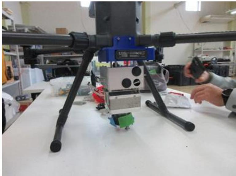
Fig. 7-28 M300 への放射線検出器の搭載状況
