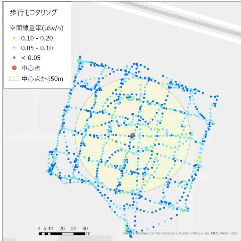
Fig. 7-34 歩行モニタリングによる空間線量率の測定結果
