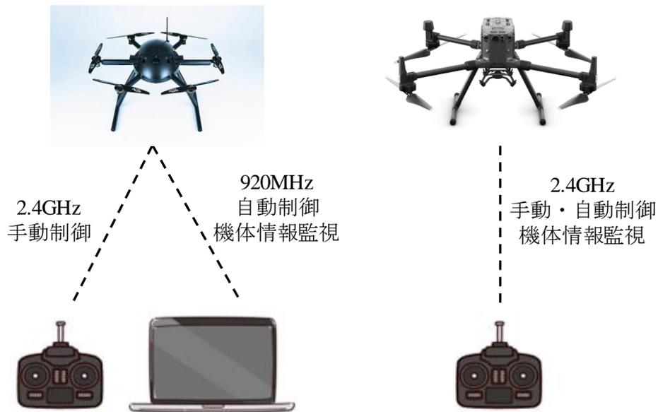
Fig. 7-23 操縦位置と通信の構成
