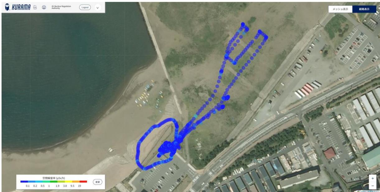
Fig. 5-5 ドローンモニタリングによる上空での空間線量率のリアルタイムマッピング結果
