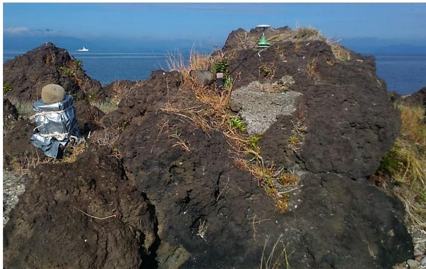
図 4 中ノ島(NAKN)における GNSS キャンペーン観測の機器設置状況
