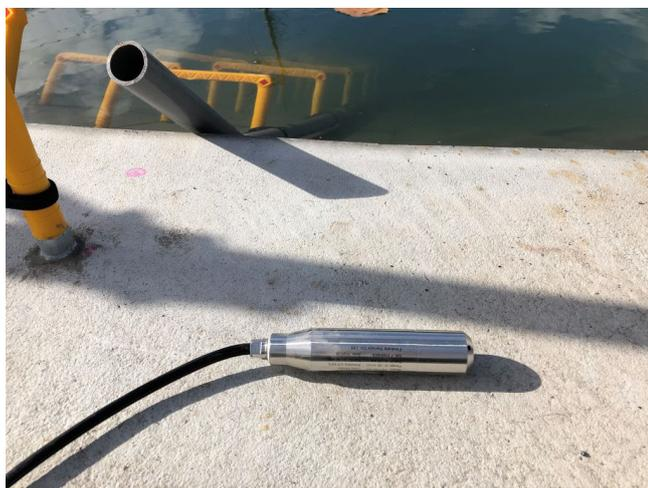
図9 水位センサー(型番 MJ-WL11-20 製造番号 F20061805. 胴直径 28 mm)。同センサー用ガイドパイプ（画面左上）
