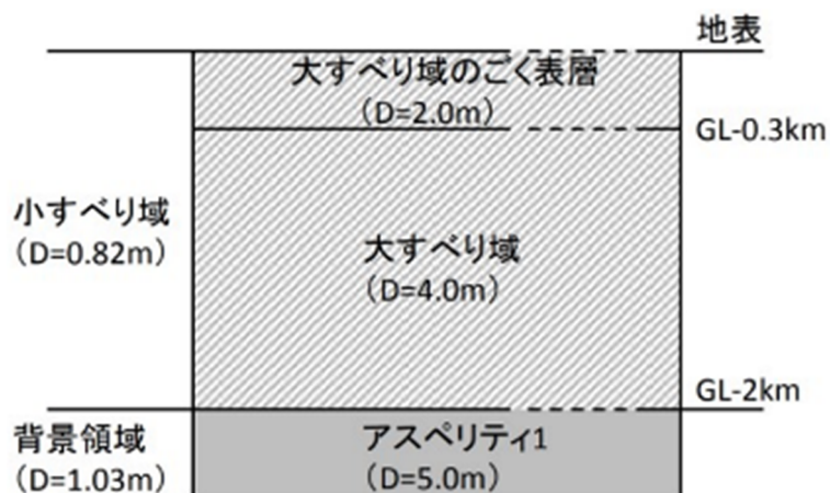
図 2-171 地表地震断層のすべり量と整合させたごく浅い断層のモデル (納所・他, 2018)
