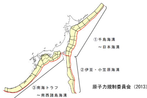
図 2-156 海溝型地震のうちプレート境界地震に起因する津波波源の対象領域 (原子力規制委員会，2013)
