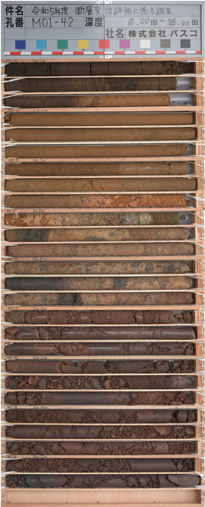
②ボーリングコア写真
