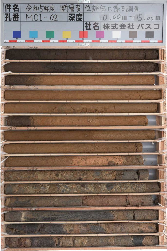
②ボーリングコア写真
