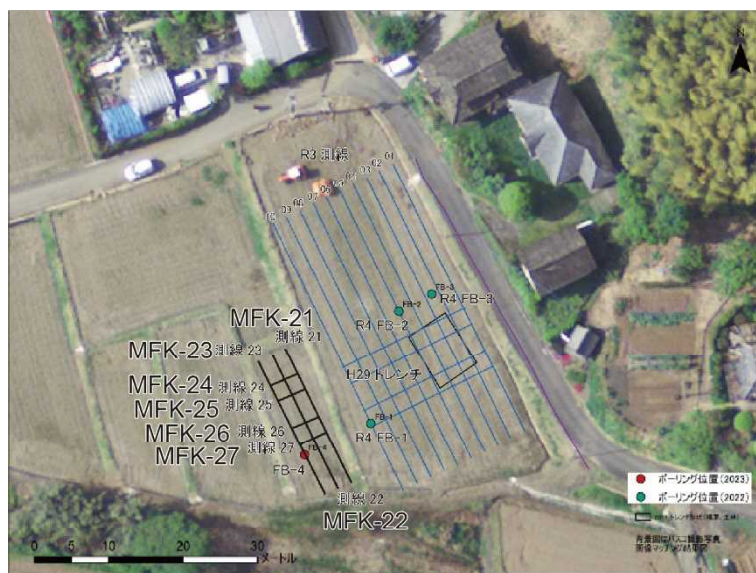
図 2.2.115 探査測線図（MFK-21 測線，再掲）
