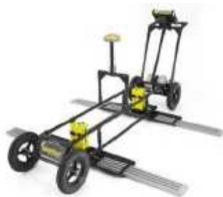
図 2.2.9 地中レーダ探査機器（pulseEKKO PRO システム）
