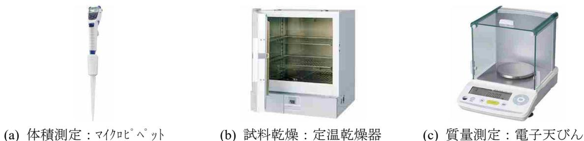
写真-4.2 底質濃度の計測機器
