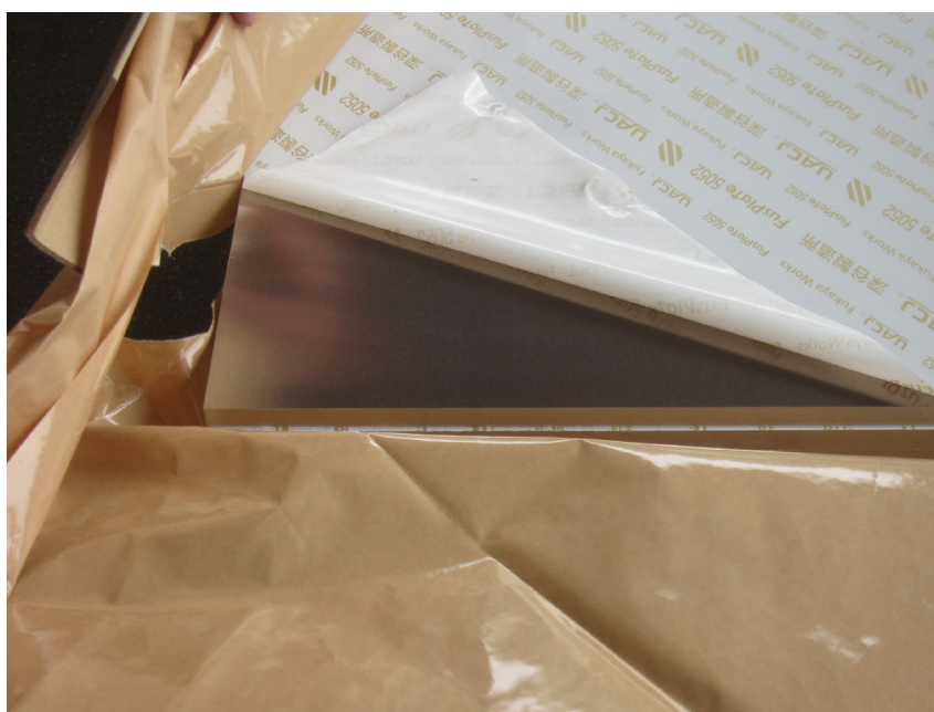
図 4.1-2 デブリ構造材模擬体（コンクリート）の上部・下部端栓に使用する材料
