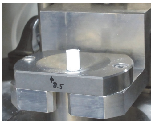
図 7.1-3 調製したデブリ模擬体ペレット例（酸化ジルコニウム）
