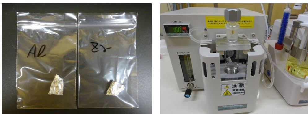
図 7.2-4 試料封入後のアルミ筒及び水分測定
