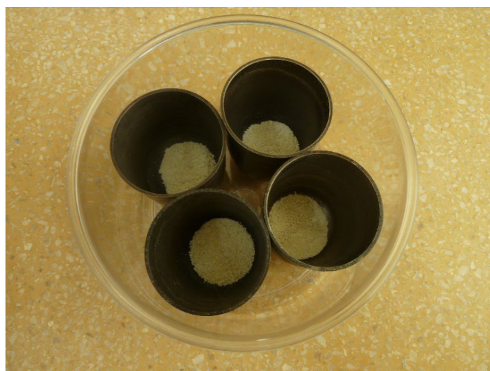
図 7.2-7 粉碎したペレット試料及び融剤分取後の状態
